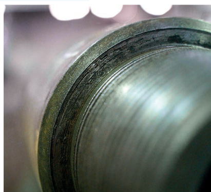
Упорный торец до перешлифовки
