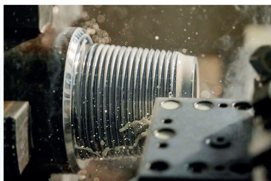
Процесс перенарезки резьбы
