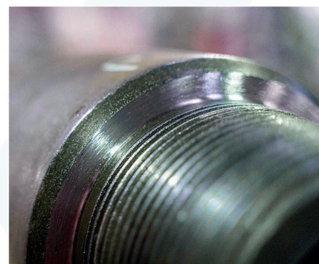
Упорный торец после перешлифовки
