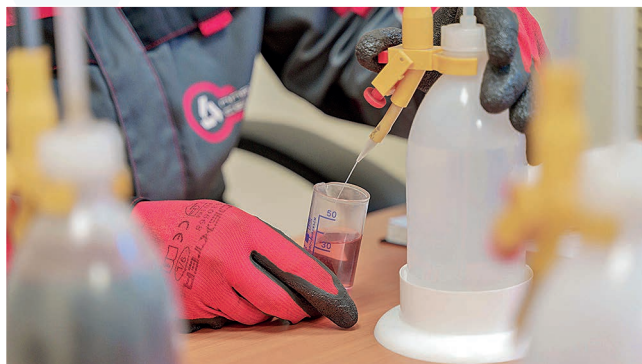
Контроль фосфатного раствора
