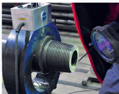
Магнитопорошковый контроль резьбы
