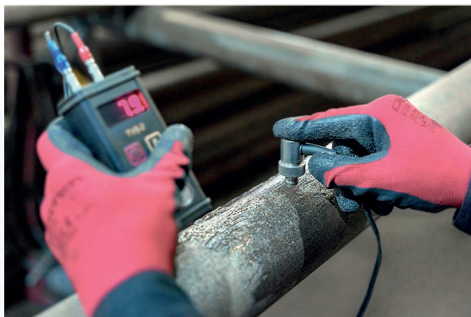
УЗТ тела бурильной трубы
