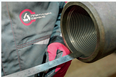
Замер глубины раззенкованной части муфты
